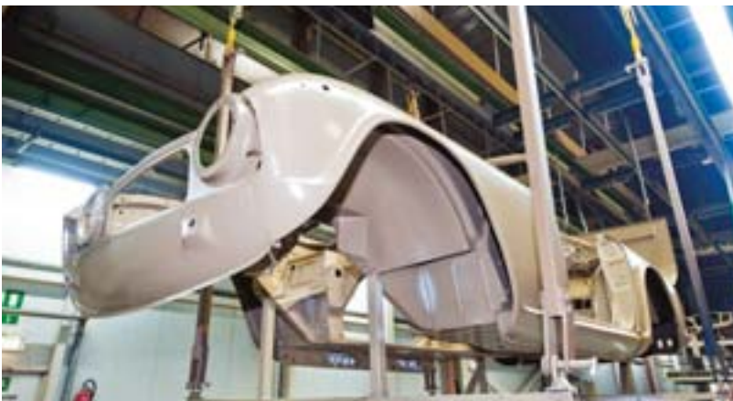
Im Tauchbad entlackt, entrostet und wieder grundiert. Firmen wie Carblast greifen für diese Leistung auf ein Netz von Spezialisten in der Industrie zurück.
