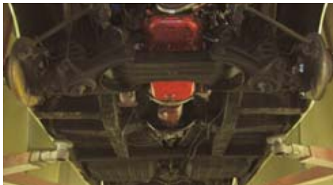
Vor und nach dem Trockeneisstrahlen. Am Unterboden zeigt dieses Verfahren, was es kann.
