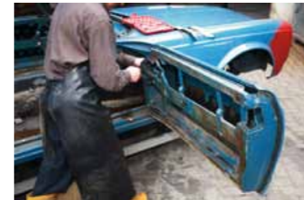
Am besten liefert man dem Entlackungsbetrieb die bereits zerlegte Karosserie an. Auch müssen alle Gummis entfernt sein
