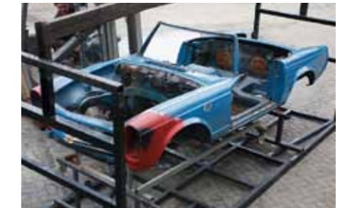
Die zerlegte Karosserie wird nun in einen speziellen Korb mit variablen Aufnahmepunkten geschraubt
