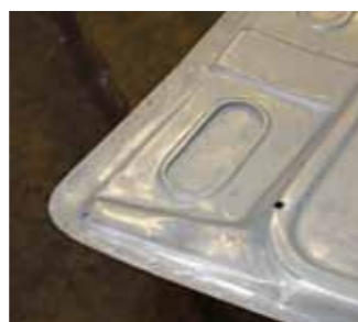
Auch Teile aus Aluminium werden mit Wasser gereinigt. Leicht sind nun alle Schäden zu erkennen
