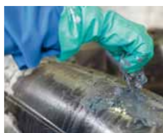
Zinn bleibt, Spachtel dagegen wird gelöst. Bei höheren Schichtstärken den Tauchgang wiederholen
