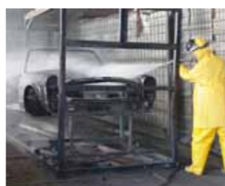
Mit hohem Druck und viel Wasser wird die Karosserie samt allen Hohlräumen sorgfältig gereinigt
