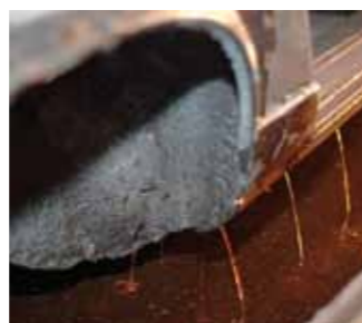
Die Lauge hat ein hohes spezifisches Gewicht. Ablaufflächen sind aus statischen Gründen nötig
