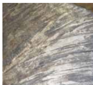
Für den Transport wird ein Rostschutz aufgesprüht. Eine dauerhafte Lösung muss schnell folgen
