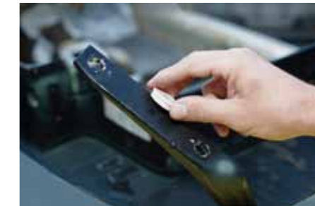
Laugenbäder eignen sich für Stahlblech, nicht jedoch für Aluminium. Ein Magnet hilft bei der Prüfung des Materials
