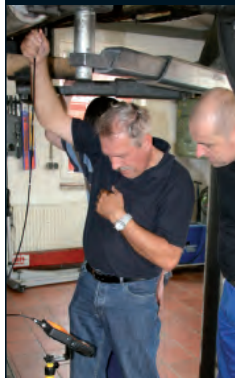
MG TD Endoskopische Prüfung der Hohlräume
